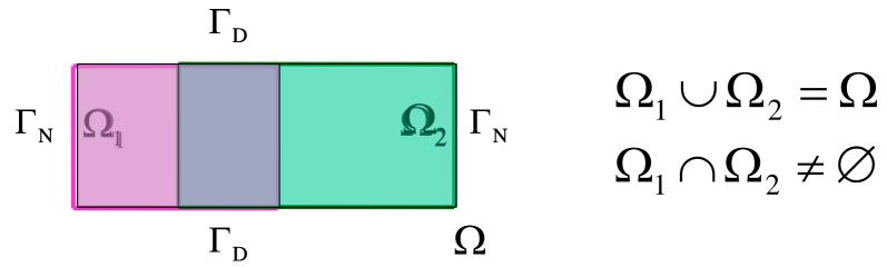
in due sottodomini  $\Omega_1$  e  $\Omega_2$  che si sovrappongono e sostituiamo la soluzione diretta di **(P)** con la soluzione della procedura iterativa nei due sottodomini.
