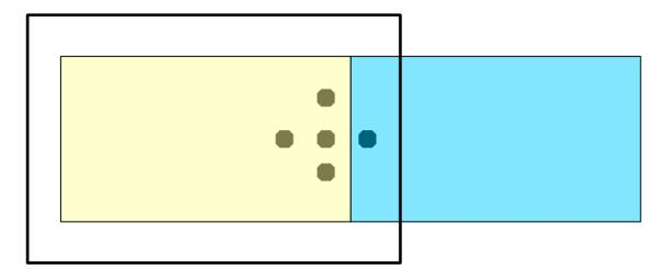
dato un blocco n\*n devo propagare una "cornice" di 4\*(n+1) elementi → overhead
