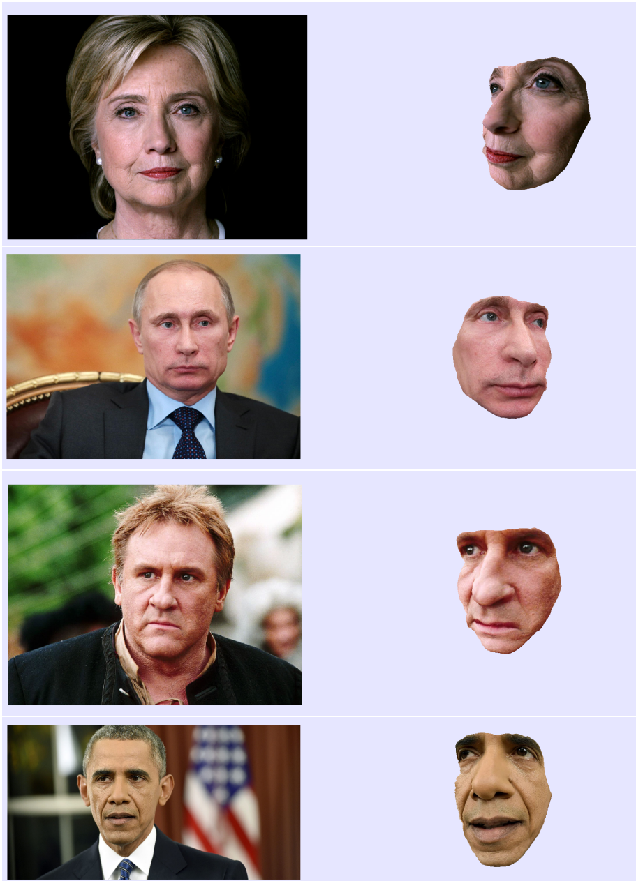
Figura 6.10: Alcune ricostruzioni da singole immagini prese dal web, ottenute combinando le normali di uno dei volti del database con le griglie e le texture delle immagini.
