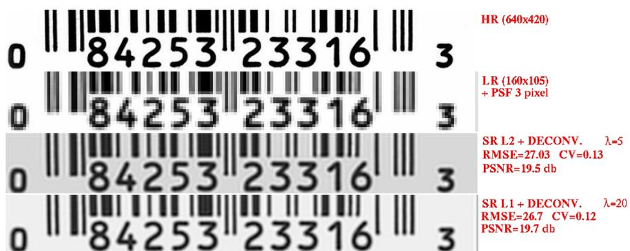
Figura 4.4: Come 4.1 ma includendo convoluzione/deconvoluzione con kernel Gaussiano FWHM=3pixel HR
