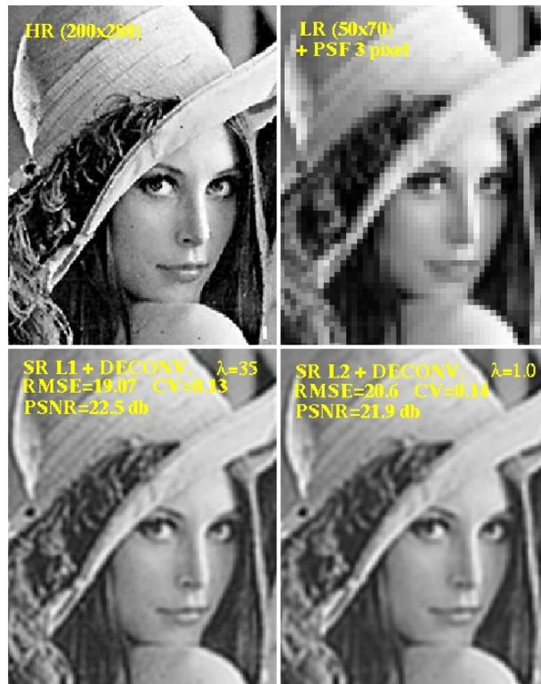
Figura 4.3: Come 4.1 ma includendo convoluzione/deconvoluzione con kernel Gaussiano FWHM=3pixel HR
