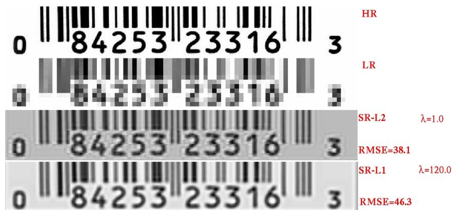
Figura 4.12: Test su immagine bar-code: super-risoluzione  $r=8$  a partire da 64 frame LR.
