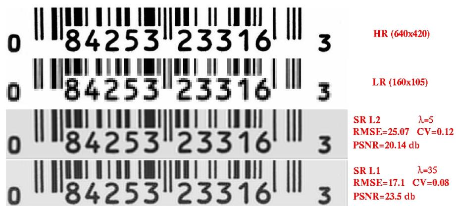
Figura 4.2: Test su immagini bar-code: immagine originale, esempio di frame LR, miglior risultato di super-risoluzione ( $r=4$  a partire da 16 frame LR) con regolarizzazioni L2 e L1
