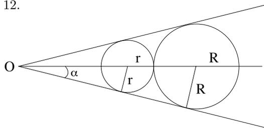
Consideriamo due biglie successive di raggi  $r < R$  e centri a distanza  $d < D$  dal vertice  $O$  del cono. Se  $\alpha$  è l'angolo di apertura del cono si ha:  $R = D \sin \alpha$ ,  $r = d \sin \alpha$  e  $D = d + r + R$ , dunque
