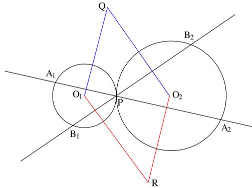
Infatti (vedi figura sopra) i centri  $Q, R$ , delle nuove circonferenze sono rispettivamente sugli assi delle corde  $A_1P, B_2P$  e  $B_1P$  e  $A_2P$ ; quindi  $O_1Q$  e  $O_2R$  sono perpendicolari alla retta  $A_1A_2$  e analogamente per  $O_2Q, O_1R$ . Tali segmenti sono quindi a due a due paralleli e formano un parallelogramma.
